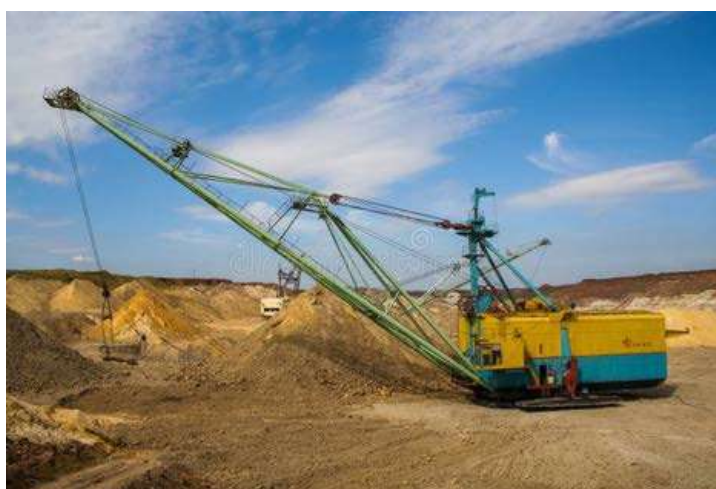
Figura 2. Draglină pășitoare / Figure 2. Walking dragline
